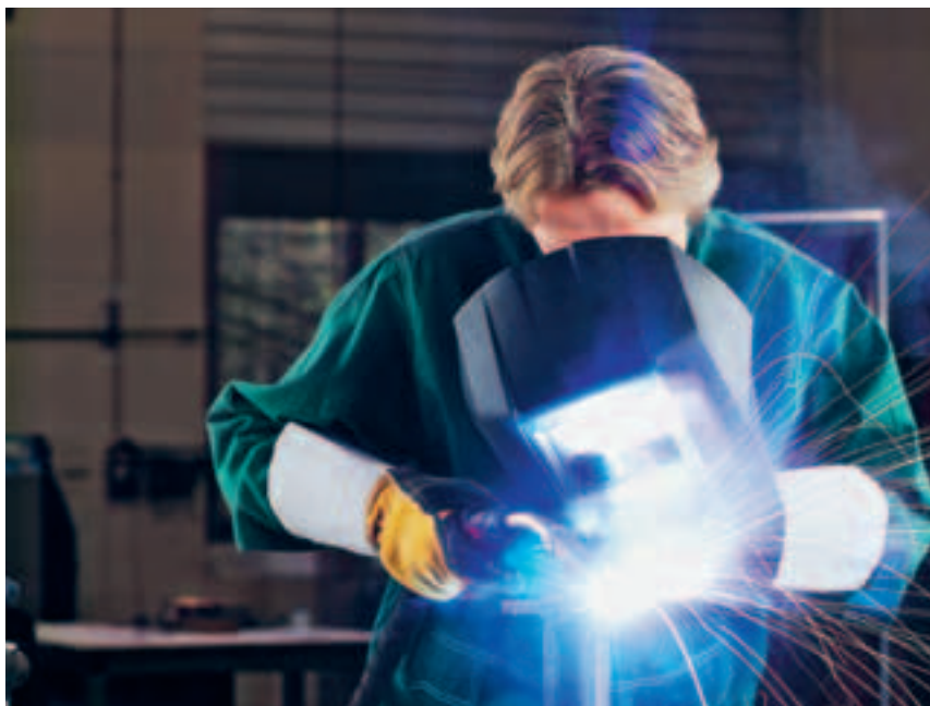
Aktive Schweisshelme – das Kerngeschäft von Optrel – dunkeln beim Schweißen selbständig ab.
